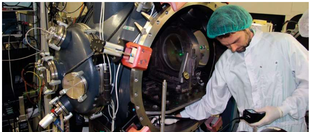
Obr. 1 Testy působení laseru Asterix na reálné vzorky meteoritů. Cílem je extrapolace parametrů aplikace výkonových laserů pro působení na nebezpečné blízkozemní objekty. Vakuovou komoru připravuje pro interakční experiment Dr. Miroslav Krůs, vedoucí Oddělení laserového plazmatu, Ústav fyziky plazmatu AV ČR.
