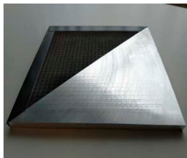
Ukázka různých struktur povrchů při využití technologie LSP
