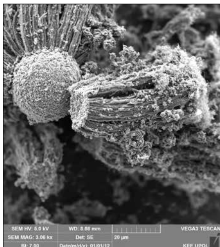
Zárodky nanovláken na ocelových mikrokuličkách pro 3D tisk
