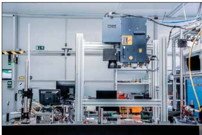
Obr. 7 Hlava Pulsar Photonics FBS na nosné konstrukci s demontovanými kryty, zdroj vlastní
