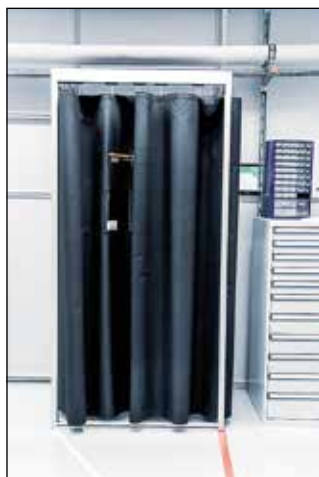
Obr. 9 Fixní (vlevo) a pohyblivá (vpravo) laserová clona, zdroj vlastní
